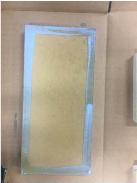
写真. 端部 3M™ 水性プライマーWP-137M 原液塗布
